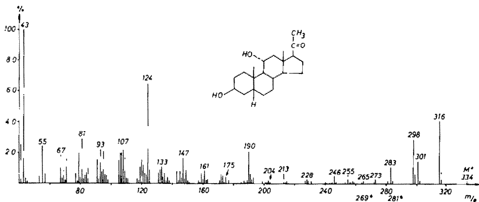
Abb. 2. Massenspektrum des 3 \beta ,11 \alpha -Dihydroxy-5 \beta -pregnan-20-ons (2).
